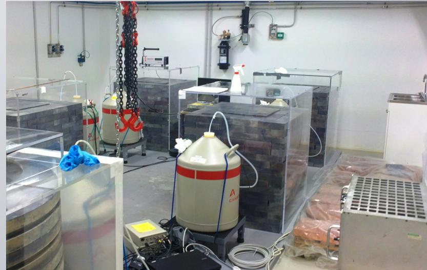
Dentro del laboratorio de Servicio de Radiopureza hay 6 detectores de HPGe, nosotros hemos utilizado para estas medidas un HPGe tipo p de Canberra con una masa de  $\sim 2,2$  kg y un fondo de  $708 \pm 3$  cpd·kg.
